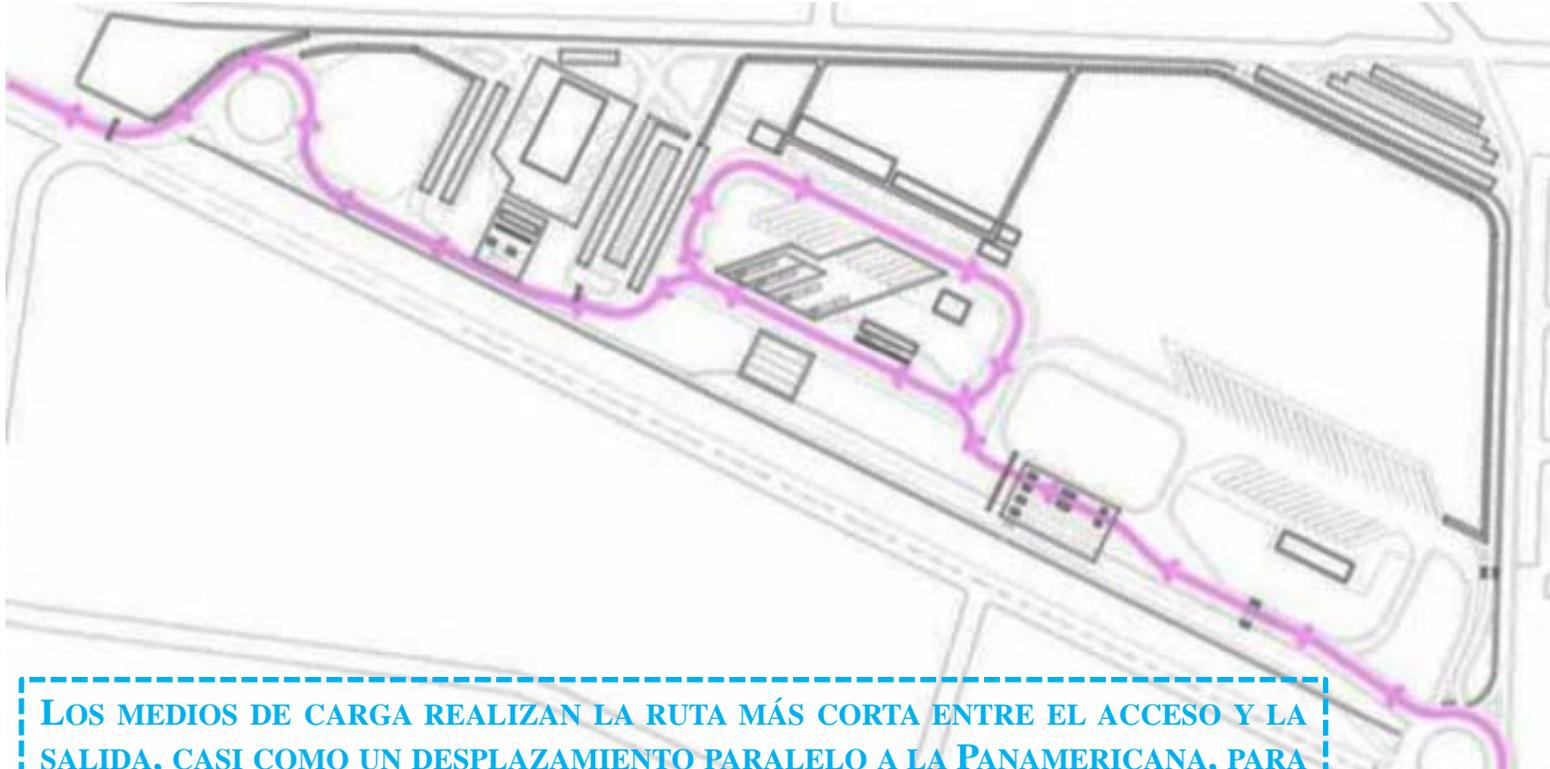
LOS MEDIOS DE CARGA REALIZAN LA RUTA MÁS CORTA ENTRE EL ACCESO Y LA SALIDA, CASI COMO UN DESPLAZAMIENTO PARALELO A LA PANAMERICANA, PARA NO PENALIZAR LOS COSTOS DEL CCI CON MAYORES LONGITUDES DE VIARIOS DE PAVIMENTO RÍGIDO.
