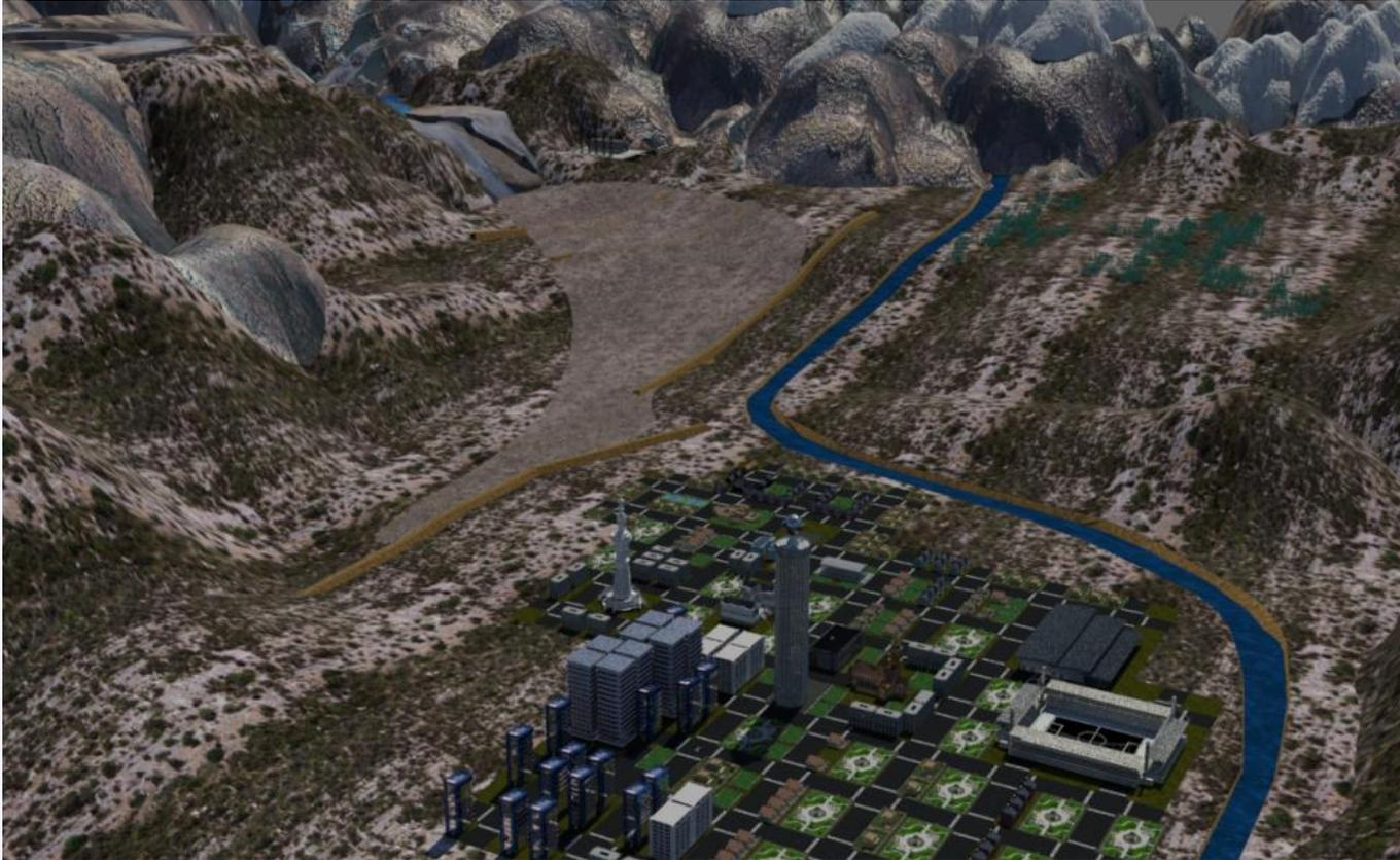
**La simulación propone conocer el área de inundación y posteriormente poder tomar decisiones para construir medidas de mitigación como muros de contención, de desviación, depresores de energía, refuerzos en las infraestructuras, entre otras.**
