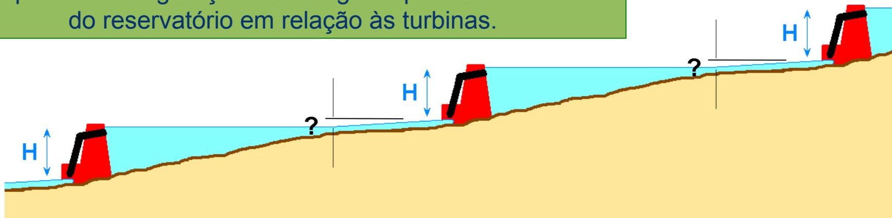
Em UHEs “em cascata”, o nível d’água (NA) em um reservatório tem que ser menor que a altitude das turbinas da usina a montante. Sem essa informação, fornecida pelas **redes geodésicas**, as margens de segurança impõem limitações significativas ao aproveitamento integral do potencial hidráulico.
