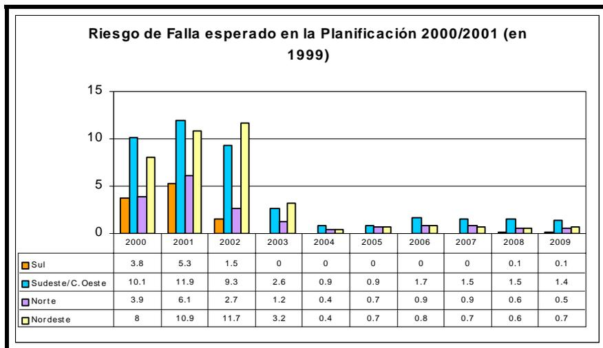
En resumen, el sistema brasileiro es un sistema donde más del 90 % de la producción proviene de fuentes hidroeléctricas. Para el año 2001 posee una capacidad de generación de 74.000 MW, y se estimó una demanda promedio estimada de 44.000 MW y una demanda máxima de 56.000 MW. Una hidrología extremadamente desfavorable en 2001, así como la falta de expansión de la generación debido al fracaso de la transición hacia un modelo de mercado causó una crisis en la oferta.
