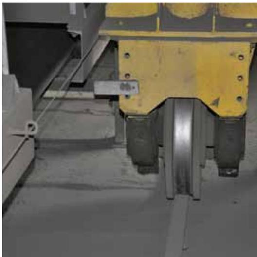
La figura 4168 muestra una imagen de la estructura móvil del Ship Loader, la cual se traslada por rieles (figura 4169) a lo largo del muelle. En la parte superior tiene una manga cerrada y una tubería de descarga para el mineral, ambas rotuladas en los extremos para adecuar la distancia a las embarcaciones.
