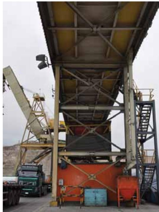
La figura 4164 muestra la llegada de la correa transportadora proveniente de los almacenes. El material llega a un contenedor dispuesto sobre una correa que transporta el mineral a lo largo de la galería.
